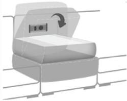
Funktionsablage mit integrierter Steckdose und USB-Anschluss.
