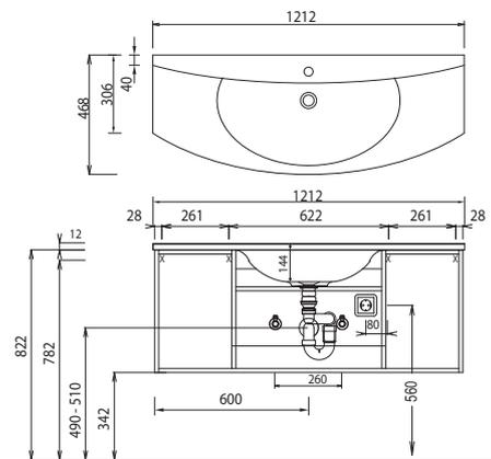
Bei Waschtischanlagen mit Befestigungsschrauben müssen die Maße zum Bohren vor Ort, nach dem Auflegen des Waschtisches auf den Unterschrank, angezeichnet werden.
