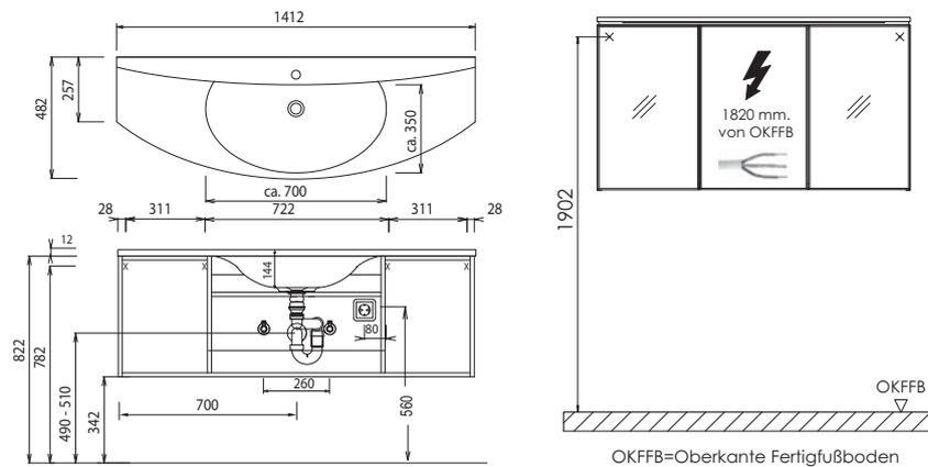
Bei Waschtischanlagen mit Befestigungsschrauben müssen die Maße zum Bohren vor Ort, nach dem Auflegen des Waschtisches auf den Unterschrank, angezeichnet werden.
